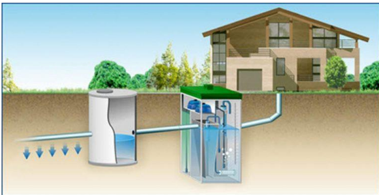
Slika 6 – Specijalizovani uređaj za prečišćavanje otpadnih voda iz domaćinstava
